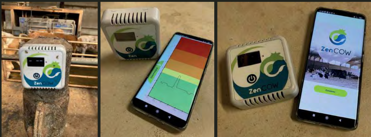
ZEN COW EST CONSTITUÉ D'UN CAPTEUR DE THI (INDICE TEMPÉRATURE-HUMIDITÉ RELATIVE) ET D'UNE APPLICATION SUR SMARTPHONE PERMETTANT DE VISUALISER LA COURBE DE THI.
